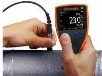
Espesor de revestimiento
